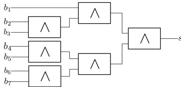
**Question 2.b** – Les circuits  $\mathcal{C}_k$  et  $\mathcal{D}_k$  représentent la fonction  $f_k : (b_1, \dots, b_k) \mapsto b_1 \wedge \dots \wedge b_k$ . En d'autres termes, c'est la fonction  $f_k : \mathcal{B}^k \rightarrow \mathcal{B}$  définie pour tout  $b = (b_1, \dots, b_k) \in \mathcal{B}^k$  par :
