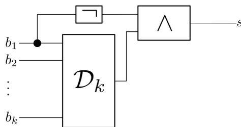
**Question 5.b** – Si  $f$  est de poids 1 alors il existe un  $k$ -uplet  $(a_1, \dots, a_k) \in \mathcal{B}^k$  tel que  $f(a_1, \dots, a_k) = 1$  et  $f(b) = 0$  pour tout  $b \neq (a_1, \dots, a_k)$ . Ainsi, pour tout  $(b_1, \dots, b_k)$ , on a :
